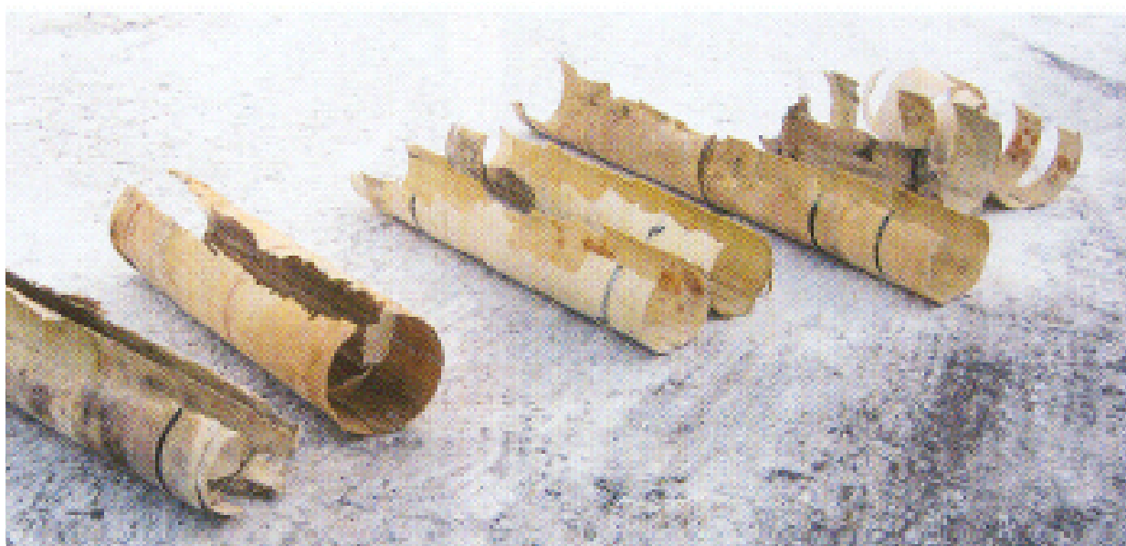
Разрушенные образцы стеклопластиковых труб в г.Тегернзее (Германия)
