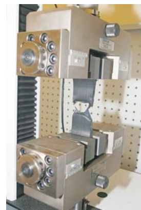
Контрольный образец в зажиме после завершения испытания
