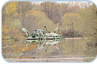
Перекачка осадка земснарядом
