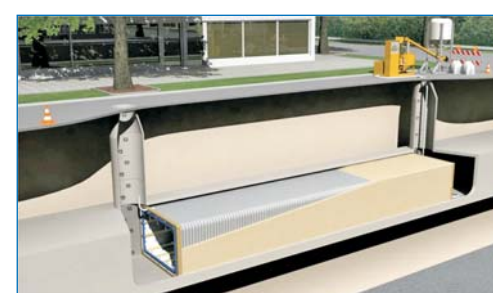
Процесс забутовки межтрубного пространства
