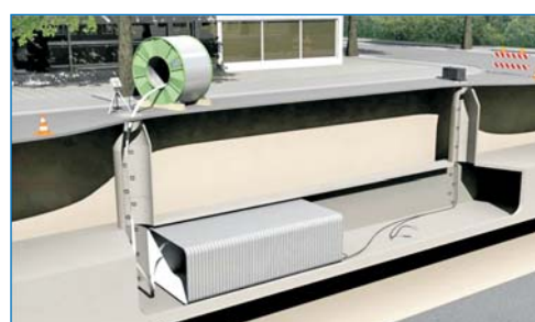
Процесс навивки нового трубопровода
