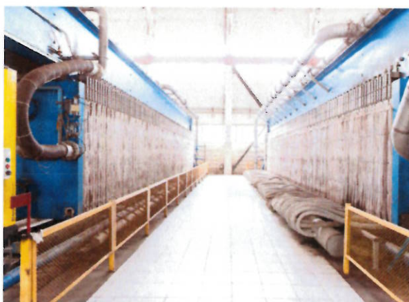
Фильтр-прессы (на фото слева) и центрифуги (справа) в цехе механического обезвоживания осадка на Ново-Люберецких очистных сооружениях
